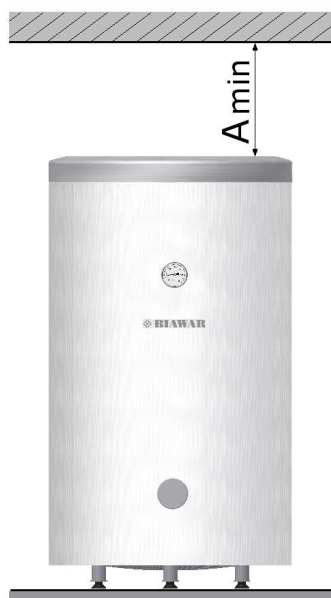
Rys. 4 Minimalna odległość do obsługi/wymiany ochronnej anody magnezowej
